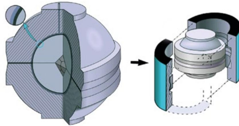
Ein Hochdruck-Hochtemperatur-Verfahren(HPHT)-Gerät, bei dem Kohlenstoffatome aus Haar und Asche in einen echten Diamanten umgewandelt werden
